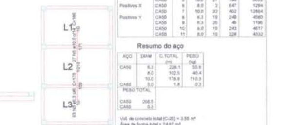
Armação negativa das lajes do pavimento Caixa D'água (Eixo Y) Escala 1:50
