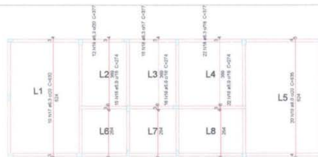
Armação positiva das lajes do pavimento Ressonancia (Eixo Y) Escala 1:50
